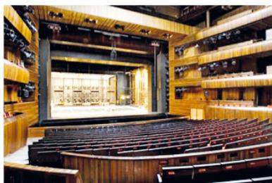
го зала служит дополнительным отражателем. Стены на каждом уровне обшиты дубовыми выгнутыми панелями таким образом, чтобы звук равномерно распространялся по всему залу, без какой-либо фокусировки звуковых волн.
