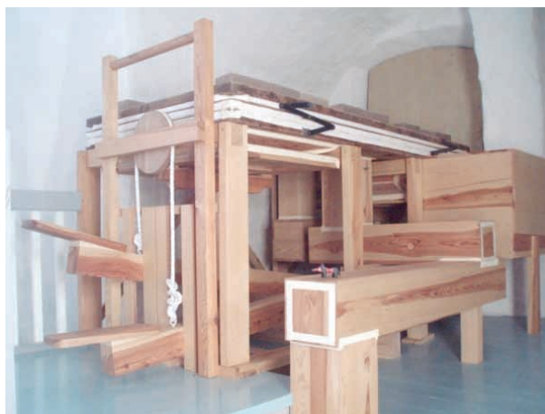
Ил. 11. Реконструкция системы мехов
