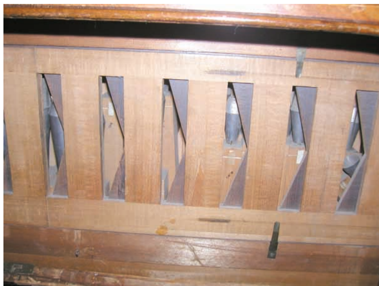
Устройство crescendo и puzucup Clarinet в fortepiano organisé И. Габрана
