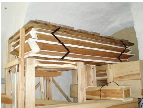
Ил. 12. Реконструированные мехи органа в действии
