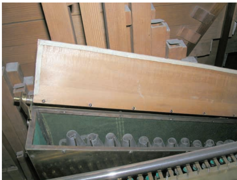
Устройство crescendo и регистр Vox humana в механическом оркестре
