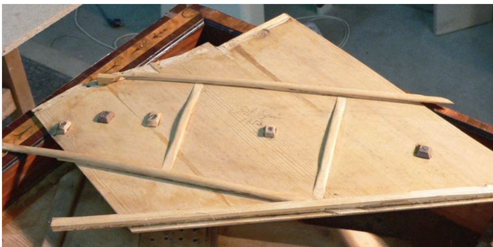
Ил. 5. Демонтаж деки
