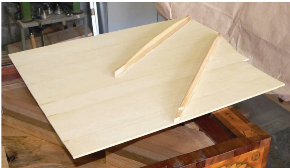
Ил. 6. Новая дека с пружинами оригинальной конструкции
